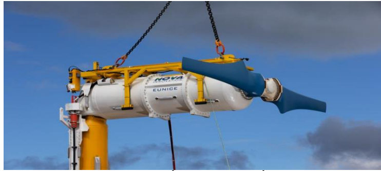
Hình 48: Tuabin truyền động trực tiếp 500 kW [16]
